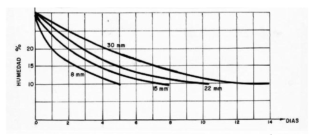
EXPERIMENTO DE SECADO DE TABLAS DE PINO EN UN SECADOR DE PETRÓLEO
